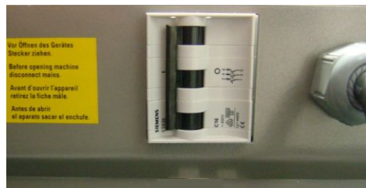
写真. ヒューズ, デバイスヒューズ 3-軸 C16A
