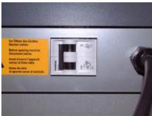
Плавкий предохранитель / кнопка ON-OFF 2-полярный C16A
